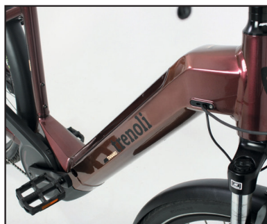
Der Powertube Akku ist im Rahmen integriert.
